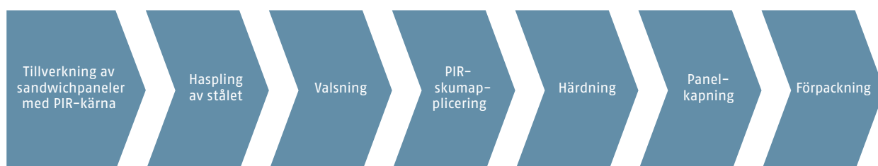
Illustration 2. Produktionsprocess för sandwichpanel
