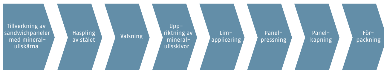
Illustration 2. Produktionsprocess för sandwichpanel
